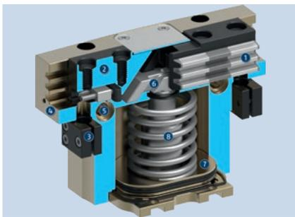
Le maintien mécanique de la force de préhension garantit une force de préhension minimale même en cas de chute de pression. Dans la version AS, cela agit comme une force à la fermeture, et dans la version IS comme une force à l'ouverture. L'image montre la version AS. Le maintien de la force de préhension peut également être utilisé pour augmenter la force de préhension ou pour une préhension en simple effet.
