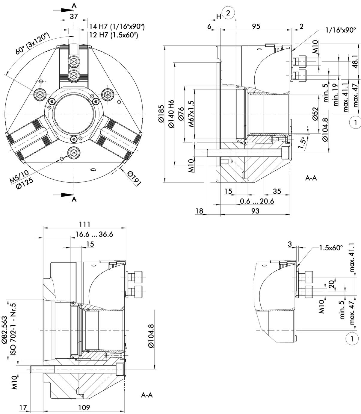
Futter für Wellenspannung in geöffneter Stellung dargestellt.
