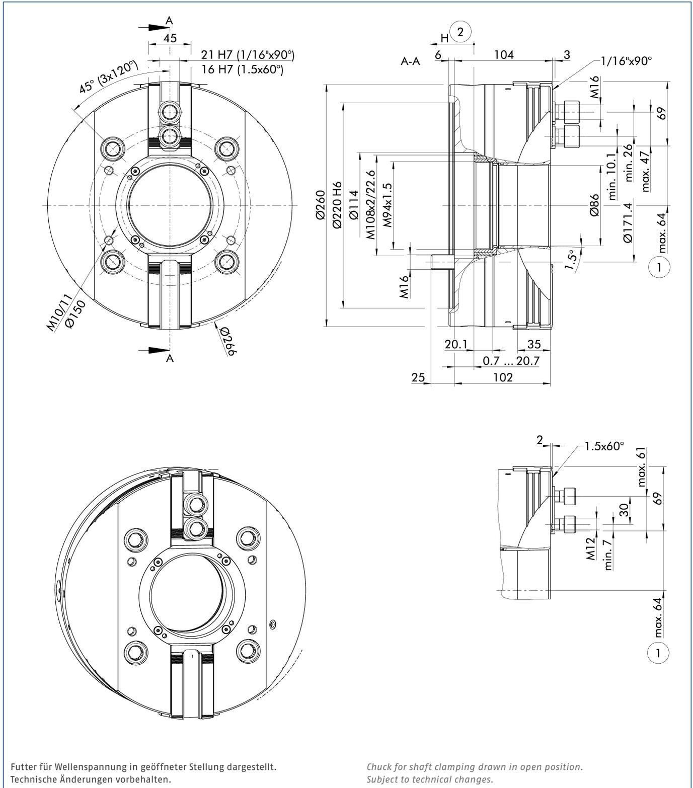
Futter für Wellenspannung in geöffneter Stellung dargestellt.
