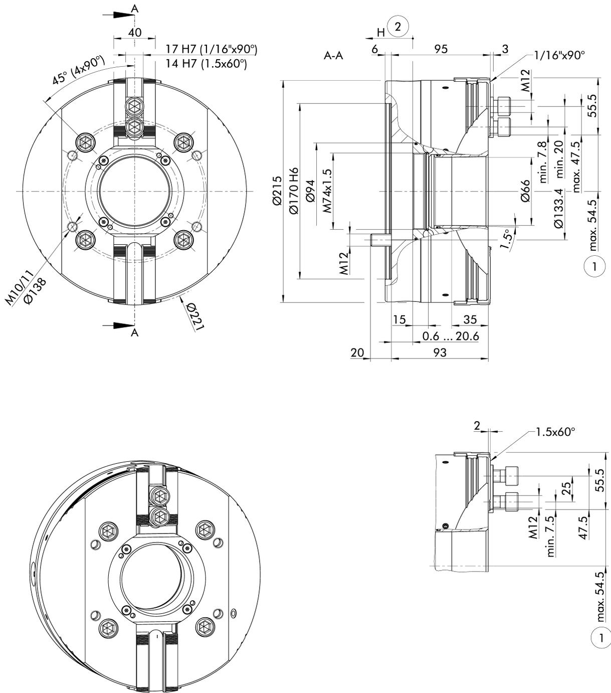
Futter für Wellenspannung in geöffneter Stellung dargestellt.
