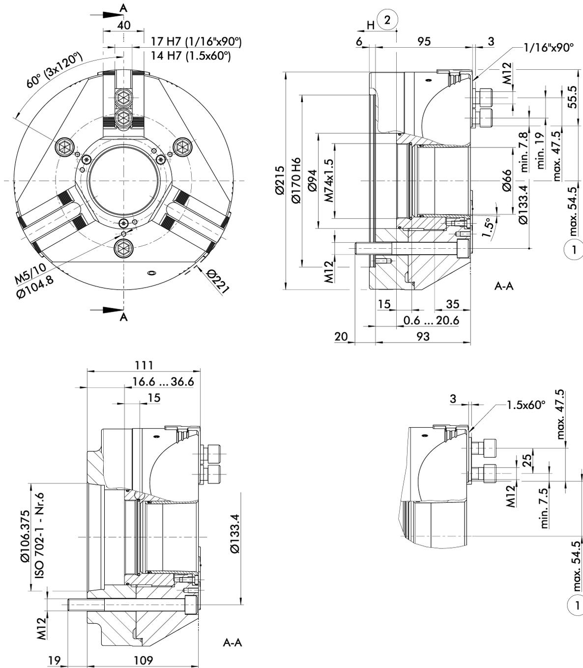
Futter für Wellenspannung in geöffneter Stellung dargestellt.
