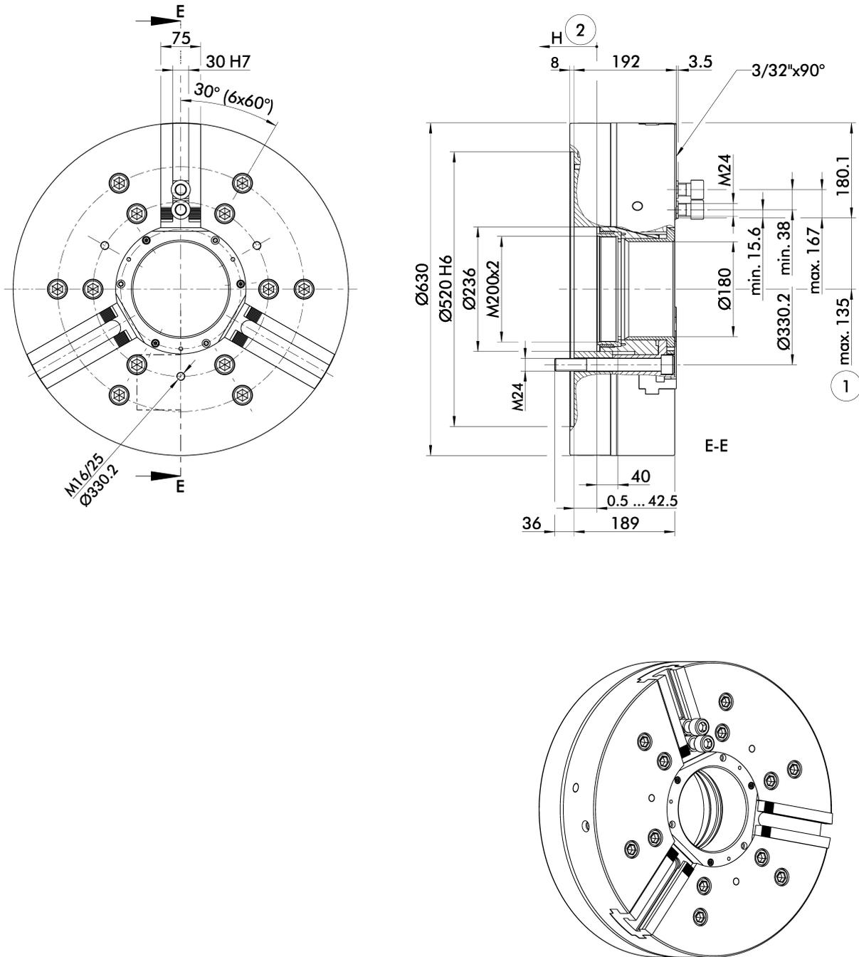
Futter für Wellenspannung in geöffneter Stellung dargestellt.
