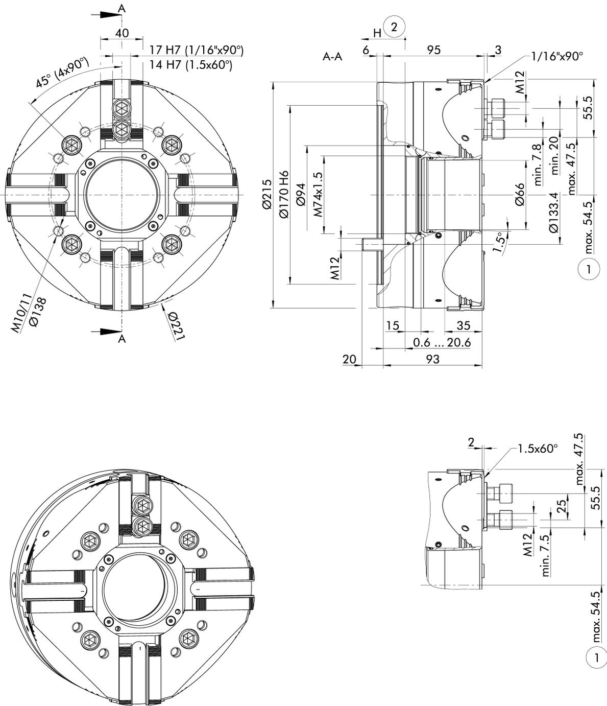
Futter für Wellenspannung in geöffneter Stellung dargestellt.
