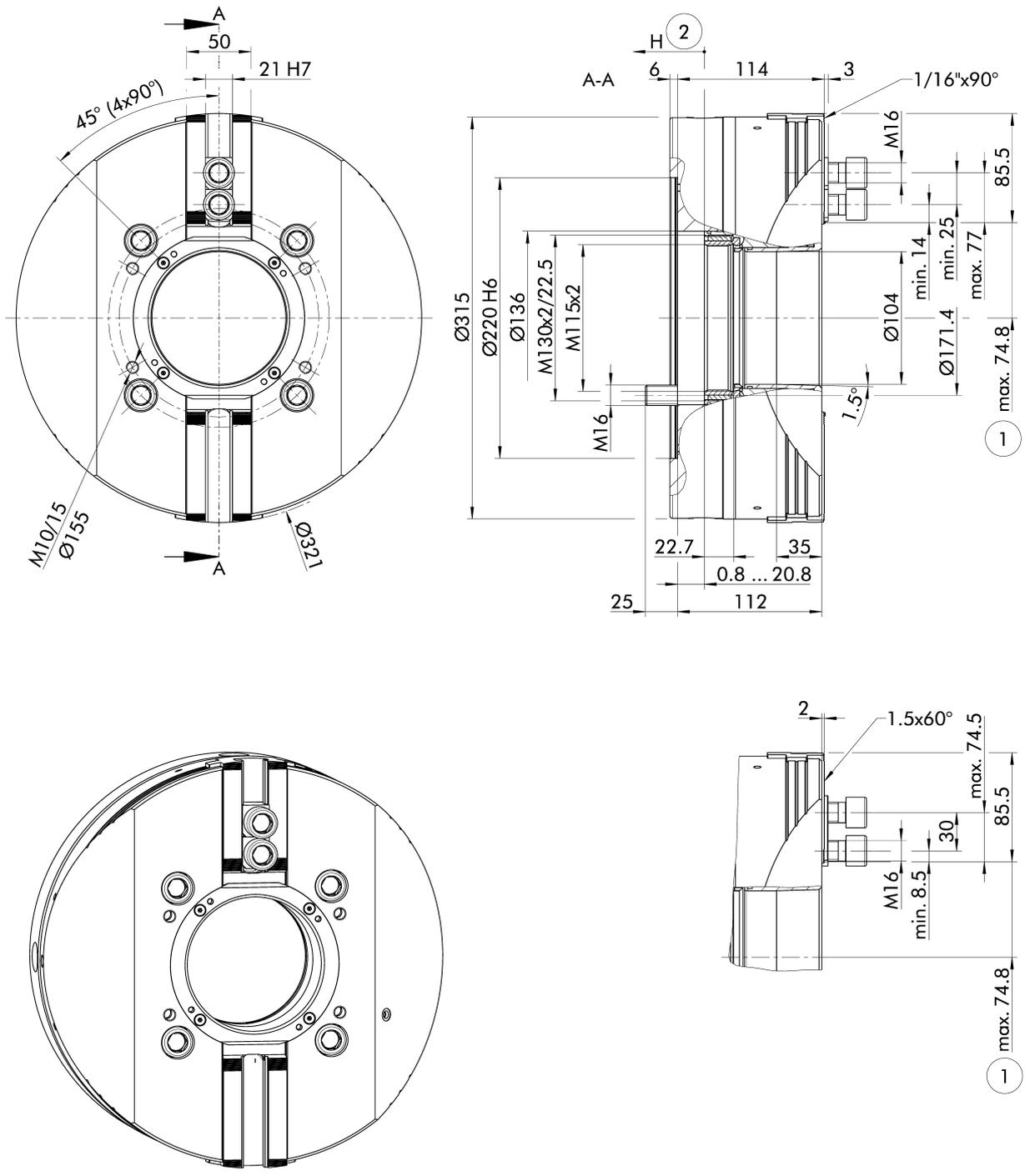
Futter für Wellenspannung in geöffneter Stellung dargestellt.
