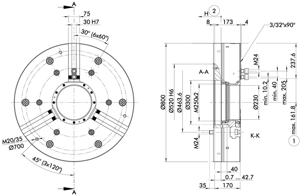
Futter für Wellenspannung in geöffneter Stellung dargestellt.
