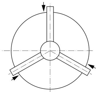
Zur optimalen Fettverteilung müssen die Grundbacken in die bei Außenspannung geöffnete Stellung gefahren, das Kraftspannfutter abgeschmiert und die Grundbacken anschließend wieder geschlossen werden. Diesen Vorgang noch einmal wiederholen.
