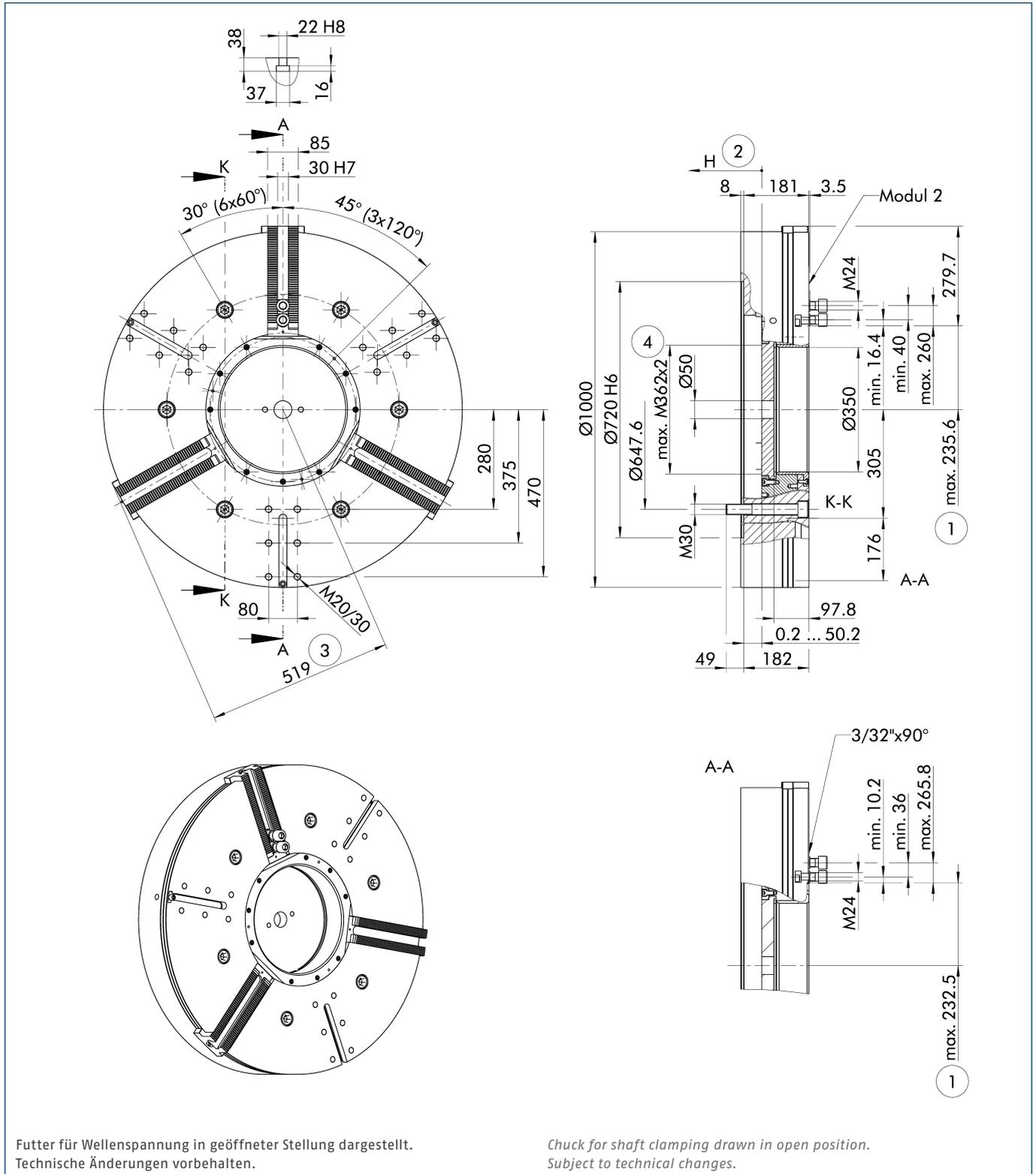
Futter für Wellenspannung in geöffneter Stellung dargestellt.
