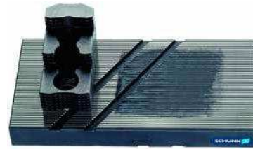
Spannbacke über der Schleifpaste aufsetzen, in die Verzahnung führen und hin und her bewegen Insert jaw on top of the grinding compound, guide it into the serration and move back and forth
