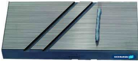
Bei gehärteten Spannbacken Schleifpaste (Korn 320) am äußeren Rand auftragen With hardened jaws apply grinding compound near the outer edge
