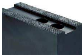
Spannbacken vor der Reinigung Serration before cleaning
