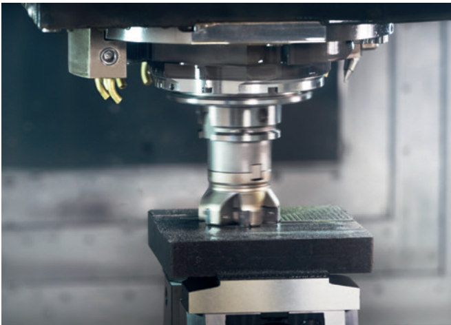
Schruppen mit Messerkopfaufnahme
