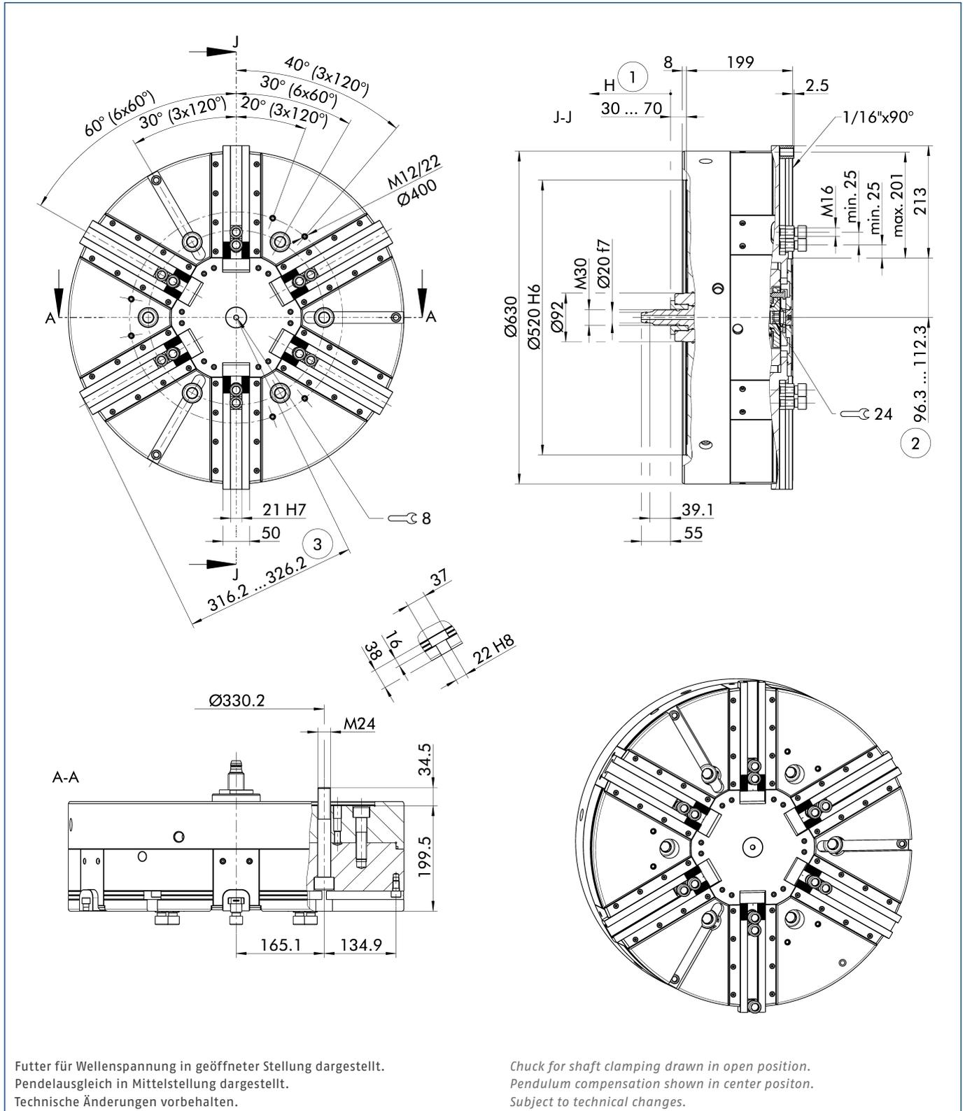
Futter für Wellenspannung in geöffneter Stellung dargestellt.
