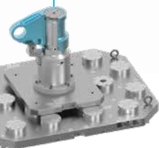
Serraggio del componente del carrello di atterraggio: grillo di fissaggio
