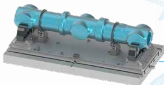
Serraggio del componente del carrello di atterraggio I bogie beam
