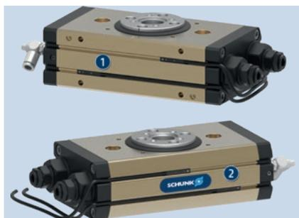
Hay dos ranuras C en cada lateral de la unidad de giro SRM, en las cuales pueden introducirse los sensores magnéticos MMS de SCHUNK. Esto garantiza un control flexible de las posiciones finales, independientemente de la posición de instalación de la SRM.
