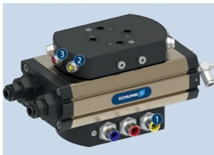
La unidad giratoria SRM puede equiparse opcionalmente con un paso eléctrico giratorio, lo cual garantiza el paso fiable de las señales eléctricas desde el punto de vista operativo. El paso eléctrico giratorio viene equipado a ambos lados con conectores de cables M8 o M12, estandarizados y con codificación de color, que simplifican la identificación del flujo de señales y facilitan la puesta en funcionamiento.
