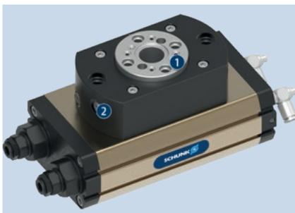
La unidad de giro SRM puede equiparse opcionalmente con un paso de fluidos que permite el paso fiable respecto al proceso de aire comprimido, gases o vacío. En el caso de los tamaños 10, 12, 14 y 16, el paso de fluidos puede realizarse opcionalmente por el orificio central y, a su vez, lo cubre. En el caso de los tamaños SRM 20, 25, 32 y 40, el gran orificio central queda completamente intacto, incluso si se elige la opción del paso de fluidos.
