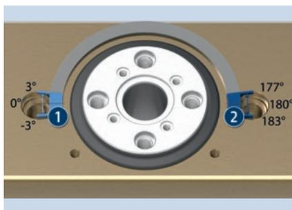
Capacidad de ajuste moderada de la posición final para ambas posiciones finales ( $\pm 3^\circ$ ) en el caso de unidades de giro con un ángulo de giro de  $180^\circ$
