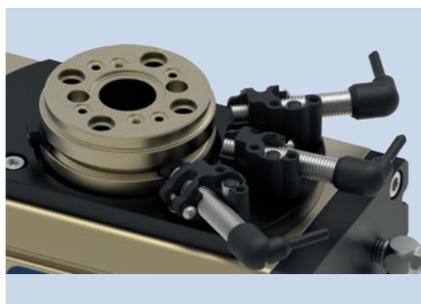
Para detectar las posiciones finales de la unidad de giro con sensores inductivos, se monta una estructura adicional en la mesa giratoria. Para un control flexible de los ángulos de giro individuales, se encuentra disponible una versión con leva de mando ajustable. Esto permite detectar hasta tres posiciones de forma inductiva.
