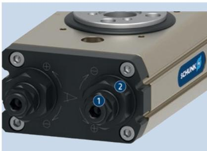
Las dos posiciones finales y la carrera respectiva del amortiguador pueden ajustarse manualmente en el lateral de la unidad. Debido al preajuste de fábrica de la carrera del amortiguador, su adaptación no es necesaria para muchas aplicaciones. Las marcas en la cubierta muestran la influencia de la dirección de rotación en el ajuste del ángulo de giro.
