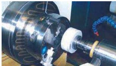
muss ein Ausdrehring möglichst dicht neben der zu schleifenden Fläche eingespannt sein (Abb. 1).
