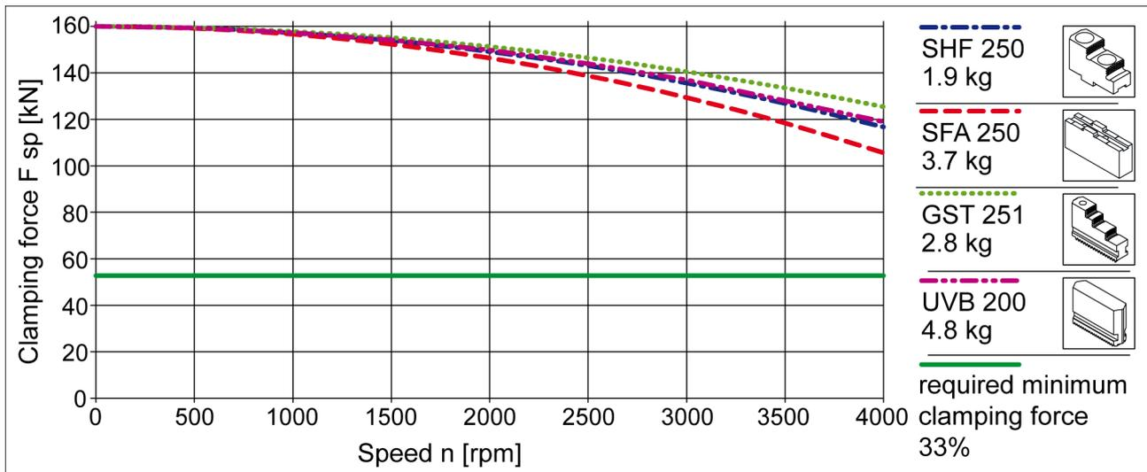
**Clamping force-RPM-diagram ROTA-G 315-102**
