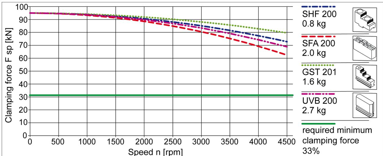
**Clamping force-RPM-diagram ROTA-G 250-82**
