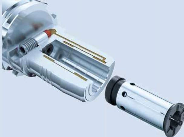
Durch den Einsatz von geschlitzten oder kühlmitteldichten Zwischenbüchsen können mit einem Werkzeughalter unterschiedliche Werkzeugdurchmesser gespannt werden. So ist ein Werkzeughalter im Spannbereich flexibel einsetzbar.
