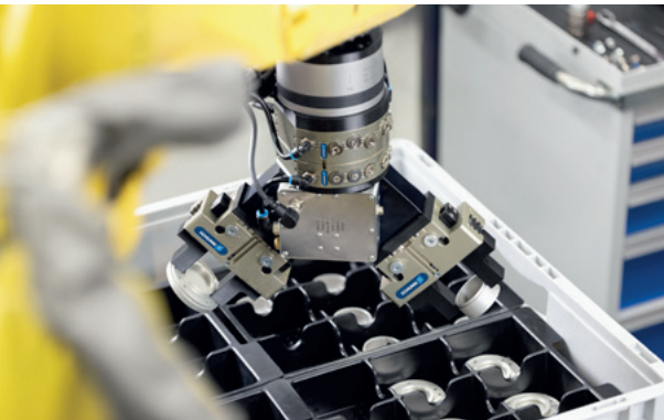
Doppelgreifer für flexible Werkstückhandhabung
