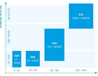
Stroke per jaw [mm]
