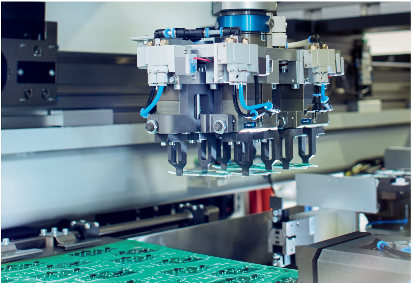
Der modulare Multigreifer greift mehrere Einzelschaltungen gleichzeitig und sorgt für kurze Taktzeiten und hohe Flexibilität. Das Torquemodul ERD überträgt Pneumatik und Sensordaten zuverlässig während der Drehbewegung.
