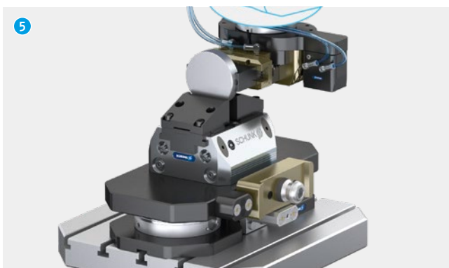
Werkstück wird in das Spannmittel automatisch eingesetzt
