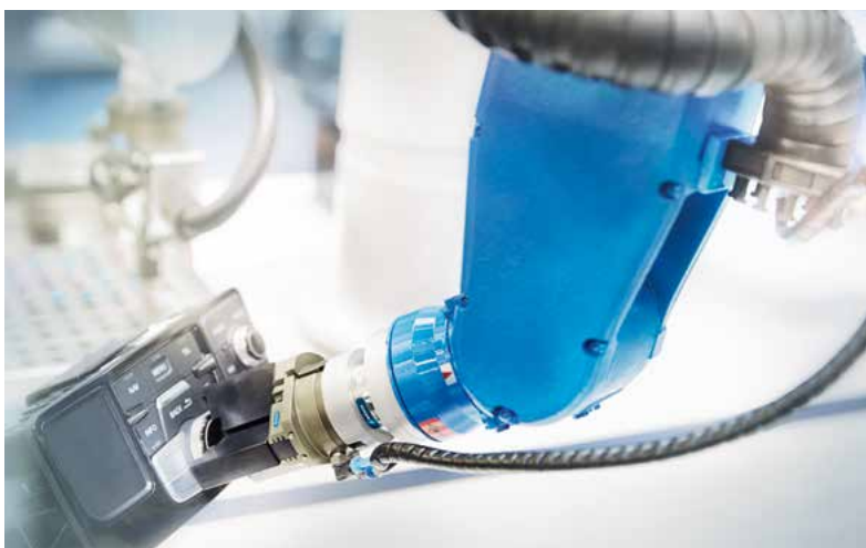
Haptikmessung von Fahrzeugkomponenten
