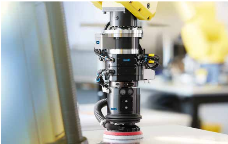
Automatisiertes Schleifen mit dem Roboter
