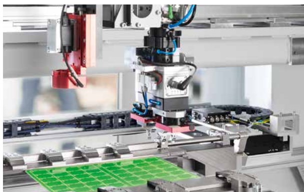
Handhabung von Leiterplatten in der Elektronikfertigung
